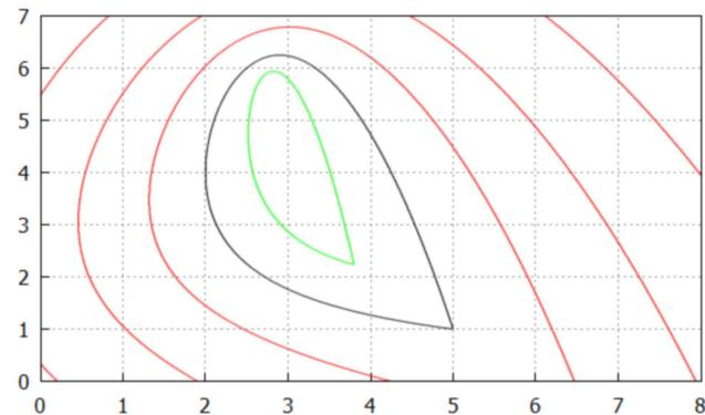
Isolinien für die Dämpfung in Abhängigkeit der Parameter  $a$  und  $b$ . Die schwarze Linie bei der Dämpfung 0 kennzeichnet die Stabilitätsgrenze, die grünen Linien kennzeichnen den stabilen Bereich, die roten den instabilen Bereich.
